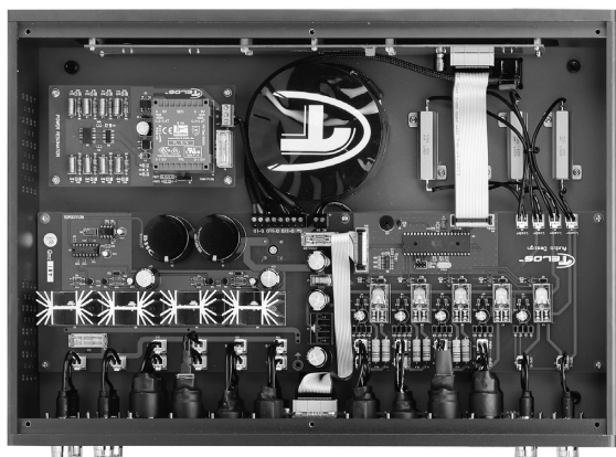
[写真22] 2016年型QBTの内部。左側に変調回路とケーブル給電回路、右側にダミー抵抗/制御マイコン/ケーブル選択リレーがある
