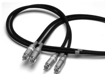
【写真15】 ハイC/PのRCAラインケーブルLINE-1.0R-TripleC-FM。PC-TripleC 導体を採用したファインメットビーズ付き2芯シールドケーブル
