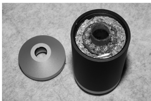
【写真8】 磁気型ノイズフィルター MD-Kユニットの内部。同極性の丸棒磁石をケーブルの周囲に12個ずつ2段に並べて磁界のトンネルを作り、給電線から出る磁界を打ち消すようだ
