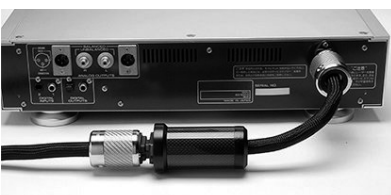
【写真10】 RAS-14 TripleCの使用例。オーディオ機器のIEC電源端子と電源ケーブルIECプラグの間に本機を挿入する
