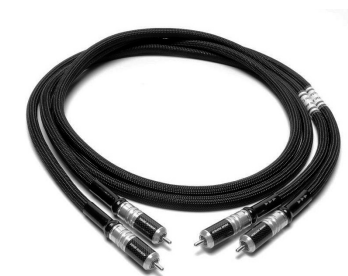
【写真18】 フラッグシップRCAラインケーブルRCA-absolute-FM。導体にPC-TripleC/EX，絶縁材にテフロン，緩衝材に天然シルクを用いた2芯シールドケーブル。RCAプラグは新開発
