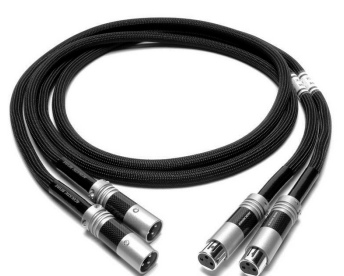
【写真19】 フラッグシップXLRバランスケーブルXLR-absolute-FM。導体にPC-TripleC/EX，絶縁材にテフロン，緩衝材に天然シルクを用いた3芯シールドケーブル。XLRプラグは新開発
